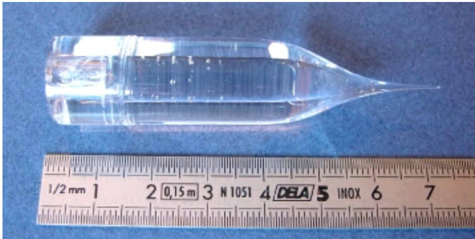
Photo 4-2 : cliché de la préforme PIG2/ZBLAYN préparée par rotational casting après fibrage
